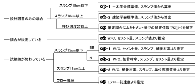
図 1 管内圧力損失推定式の使い分け
